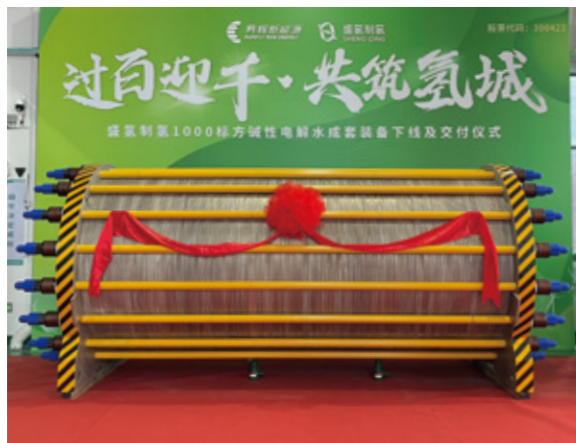
1000标方碱性电解水电解槽
